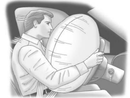
Модуль фронтальной подушки безопасности водителя встроен в ступичную часть рулевого колеса.
