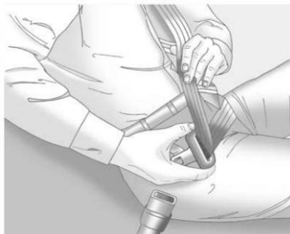
Если скоба с фиксированным положением не достает до пряжки замка, то наклоните скобу и переместите ее по лямке ремня безопасности на необходимое расстояние.
