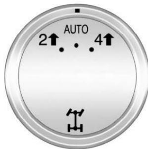
Переключатель режимов раздаточной коробки расположен на приборной панели слева от комбинации приборов.
