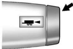
Для включения и выключения этого режима нажмите кнопку, расположенную на торце рычага селектора автоматической коробки передач.
