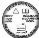
1. Дайте остыть компонентам системы охлаждения, включая расширительный бачок системы охлаждения и верхний шланг радиатора, затем снимите крышку расширительного бачка. Плавно поверните крышку против часовой стрелки. Если будет слышно шипение, подождите до тех пор, пока оно не прекратится. Шипение свидетельствует о том, что в бачке есть избыточное давление.
