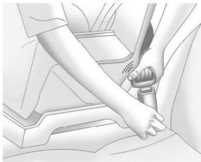
4. Вставьте скобу ремня безопасности в замок до щелчка. Определите положение кнопки разблокировки замка ремня безопасности, чтобы, при необходимости, можно было быстро отстегнуть ремень.
