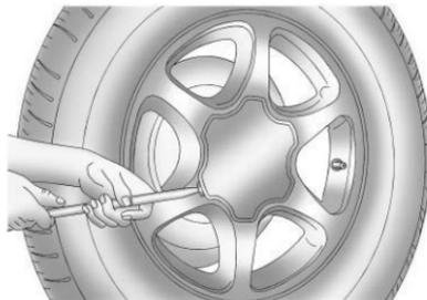
2. Если на данном автомобиле используются декоративные накладки, закрывающие места крепления колеса, установите плоский конец колесного ключа в паз и осторожно подденьте накладку.
