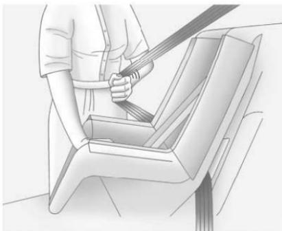
5. Вытяните плечевую лямку ремня безопасности из возвратного механизма на всю длину для активации функции блокировки. После активации функции блокировки ремень может втягиваться в возвратный механизм, но его вытягивание из него невозможно.
