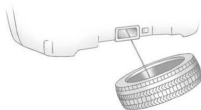
7. Чтобы получить доступ к держателю запасного колеса, наклоните колесо по направлению к автомобилю так, чтобы натяжение страховочного троса немного ослабло. Чтобы отсоединить держатель запасного колеса от прижимной планки, сдвиньте держатель вверх по прижимной планке, не отпуская защелку.
