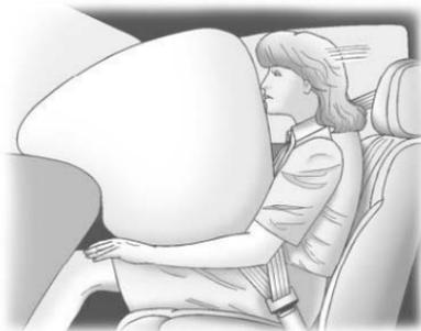
Модуль фронтальной подушки безопасности переднего пассажира встроен в приборную панель напротив переднего пассажирского сиденья.
