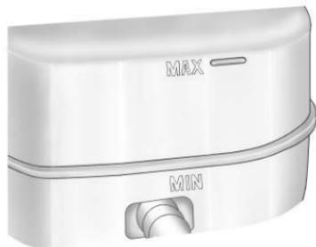
Уровень тормозной жидкости должен находиться выше метки «MIN». В противном случае проверьте тормозную систему на наличие утечек.
