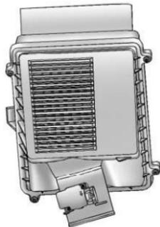
2. Выверните 4 винта крепления крышки воздухоочистителя снимите ее.
