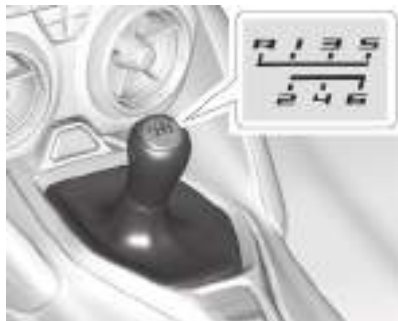
Схема переключения передач (двигатели L4 и V6)
