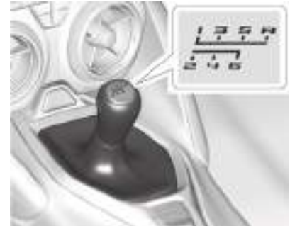
Схема переключения передач (двигатель V8)
